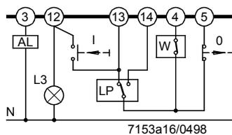
Das Einschalten des Brenners erfolgt manuell durch Taster «I». Danach programmiert der LAL... die Inbetriebsetzung und Flammenüberwachung. Abschaltung des Brenners ebenfalls manuell durch Taster «0» oder automatisch beim Ansprechen des Temperaturwächters bzw. Druckwächters (W). Signallampe (L3) zeigt die Startbereitschaft des LAL... an; sie erlischt kurz nach Beginn der Inbetriebsetzung. Übrige Anschlüsse, siehe Anschlussdiagramme.
