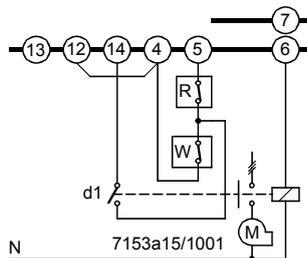
Wird ein Hilfskontakt (d1) des Gebläseschützes gemäß Schema in die Schaltung einbezogen, erfolgen Zündung und Brennstofffreigabe nur bei geschlossenem Kontakt.
