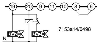
Das Relais kann entfallen, wenn Brennstoffventil 3 (BV3) an Klemme 20 hydraulisch in Serie zu Brennstoffventil 2 (BV2) installiert ist. Brennstoffventil 2 (BV2) wird von Klemme 18 oder 19 angesteuert. → Brenner ohne Luftklappe bzw. mit nicht vom LAL... gesteuerter Klappe
