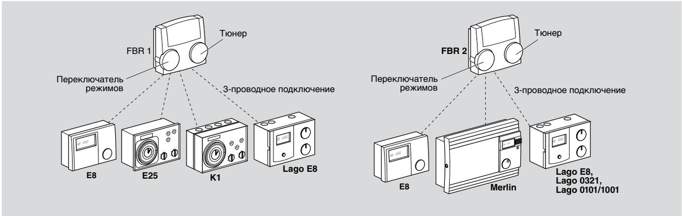
С помощью переключателя режимов через FBR в регуляторе системы для соответствующего контура отопления могут выбираться следующие режимы работы:
