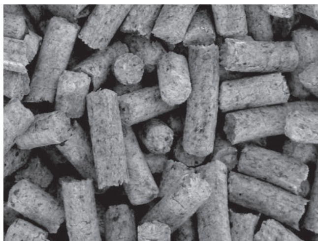
Abb. 16 – Holzpellets schlechter Qualität – Dunkelpellets mit Rinde (mit schwarzen Punkten)
