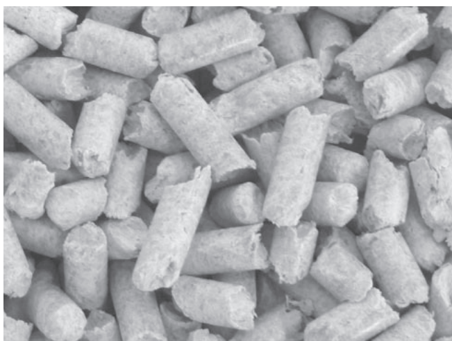
Abb. 15 – Hochwertige Holzpellets – Weißpellets ohne Schwarzpunkte (Rinde)
