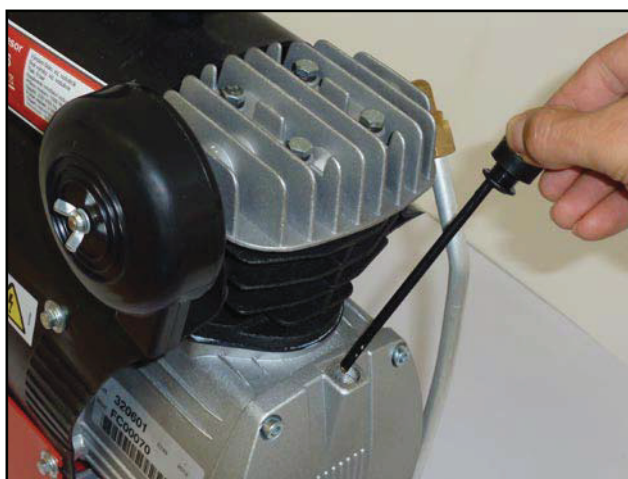
Prüfung des Ölstands im Verdichter
