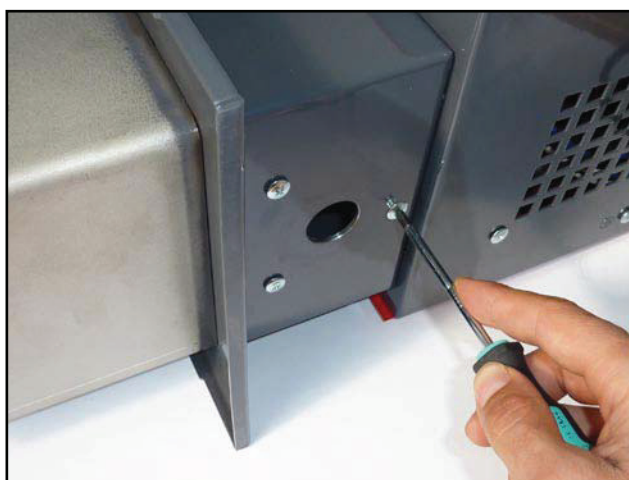
Die ursprünglichen Schrauben sind zurück zu bringen. Dabei muss man an festes Anziehen achten, um Ansaugen der Falschlufte zu vermeiden
