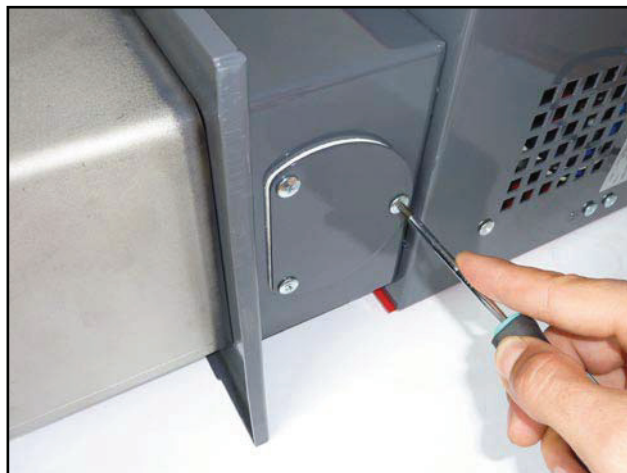
Die Abdeckung der Dichtung im unteren Brennerteil wird weggenommen
