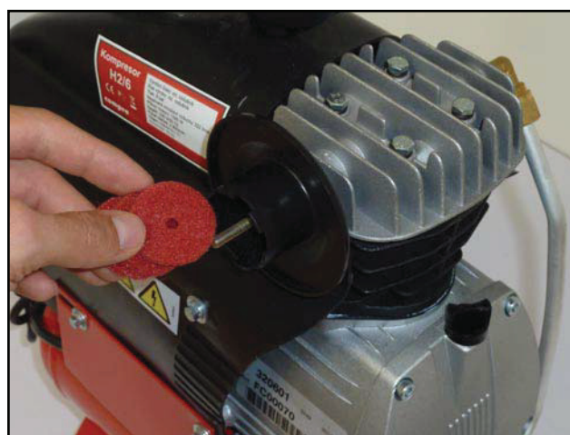
Reinigung des Verdichterfilters
