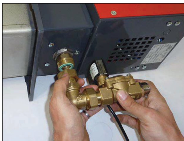
An den Brenner werden die Verschraubung mit dem Steuerelektroventil und Verbindungskabel angeschraubt
