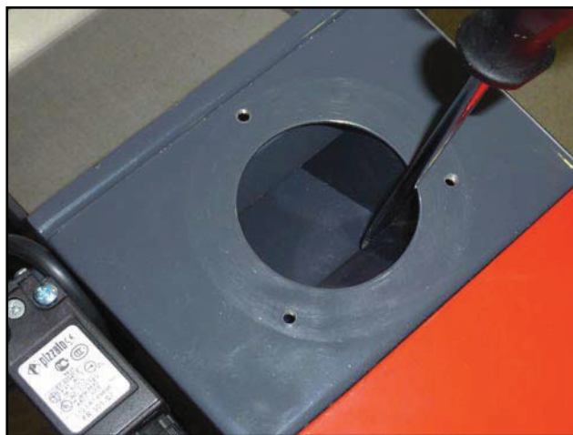
Reinigung des Bereichs unter der Rohr für die Pelletszuführung
