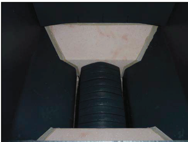
Beispiel des Vergasungsrostes für die Kessel CxxS, ACxxS, KCxxS ohne den speziellen zusätzlichen Rost
