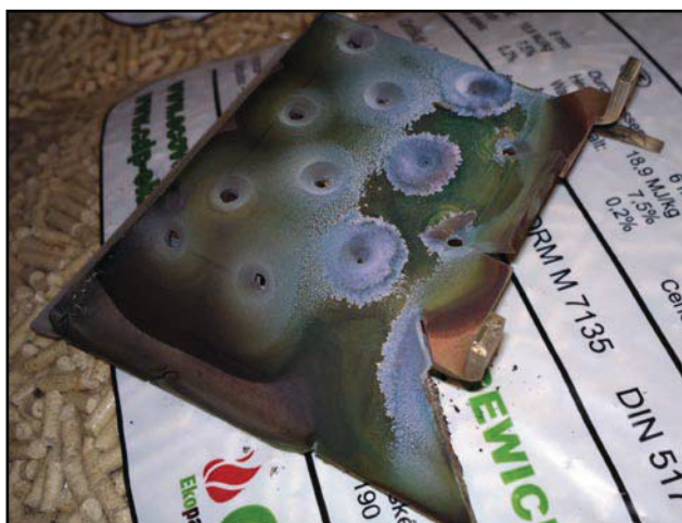
Leichte Verstopfung der Löcher in der Brennkammer nach 4 Betriebsmonaten
