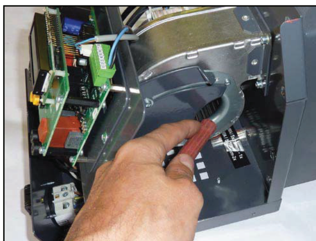
Reinigung (Ausblasen) des Laufrads des Druckventilators einmal pro Heizsaison
