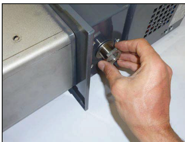
Danach wird der Kanal für pneumatische Reinigung in den Brenner eingelegt und leicht mit der Unterlegscheibe und Mutter befestigt
