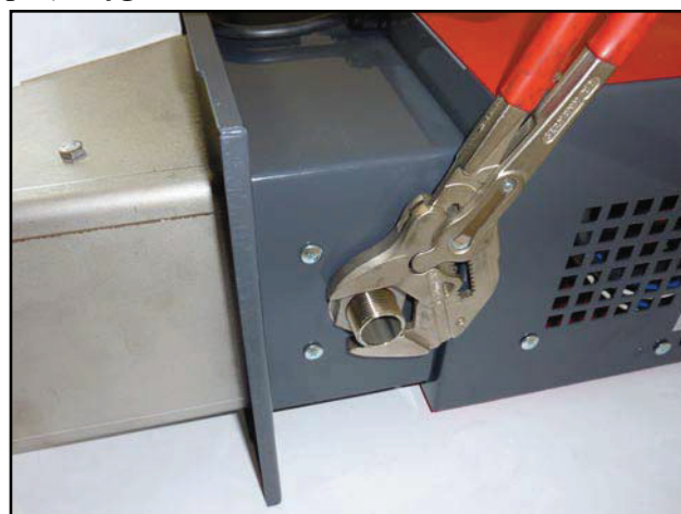
Die Sicherungsmutter mit der Unterlegscheibe ist festzuziehen
