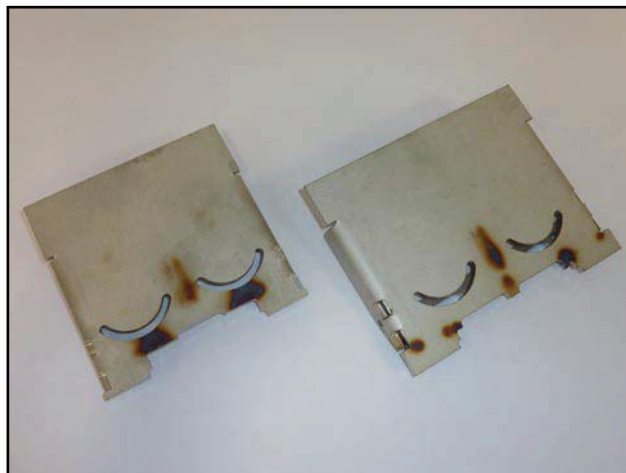
Neue Platte (Halter) der Glühspiralen für die Brenner A25 und A45
