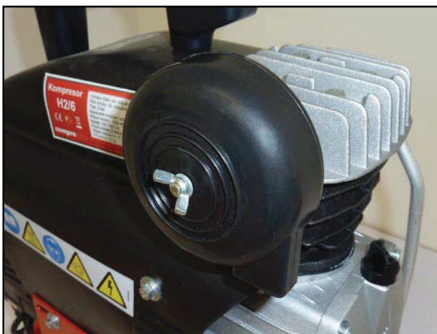
Auf dem Verdichter befestigter Saugfilter
