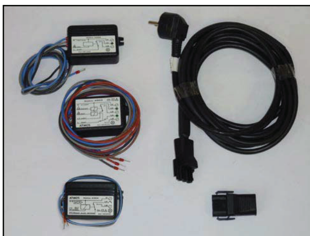
Module AD02, AD03 und AD04 Verbindungskabel mit einem Stecker mit 3 Stiften (weiblicher Teil) und der selbstständige Stecker mit 3 Stiften (männlicher Teil)
